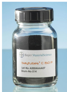
Abbildung 20: „Baytubes“ sind Nanotubes der Firma Bayer. Zu sehen ist, dass die SWNT's in Form von Pulver gelagert und verkauft werden. 63
